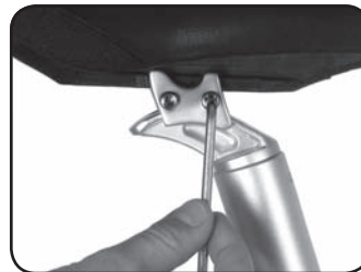
Étape 6.5 Serrez les boulons à une pression de 85 po-lb ou 9,5 NM.
