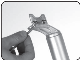
Étape 6.1 Desserrez la fixation du rail de siège Kore I-Beam avec une clé hexagonale de 4 mm.
